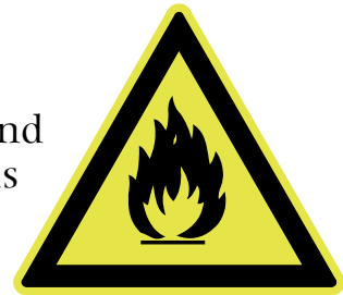
Warnung vor feuergefährlichen Stoffen
