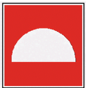
Einrichtung zur Brandbekämpfung (z. B. Feuerlöscher, Löschdecke, Löschsand)
